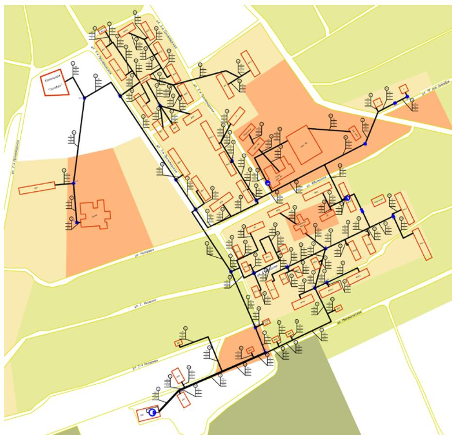
Рис. 2. Схема тепловой сети газовой котельной.
